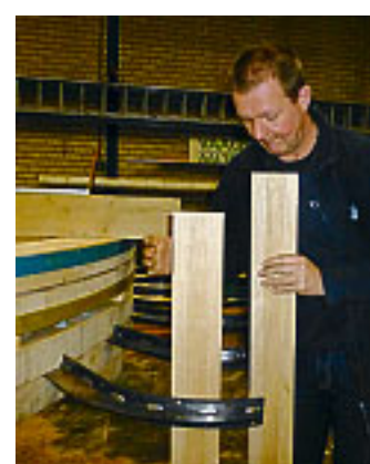
Die Schaufelbretter werden erst bei der Endmontage auf die Eisen-Schaukelteile geschraubt.
