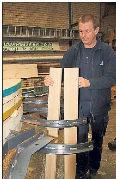
Auf die Stiele werden speziell gebogene Holzbretter montiert. So entstehen die Schaufeln.
