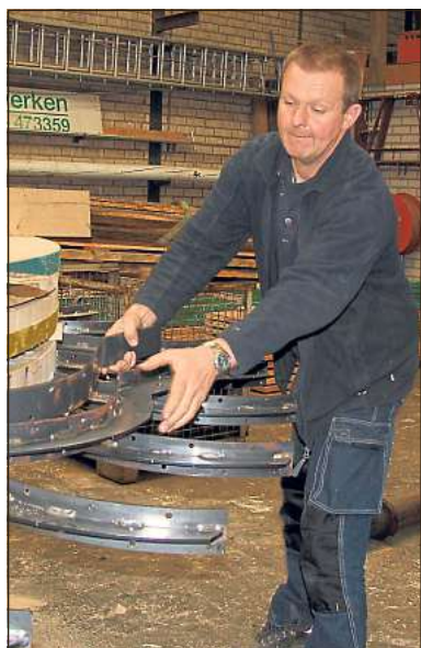
Aus Cortenstahl sind die Schaufelstiele, die Gerben Vaags am Ring befestigt hat.
