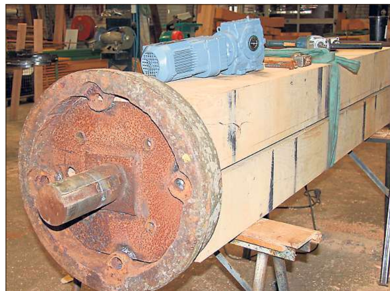
Die Achse ist als einziges Teil vom alten Mühlrad übrig geblieben und bei der Firma Vaags in Aalten komplett aufgearbeitet worden. Für den Antrieb ist der Motor (oben) zuständig.
